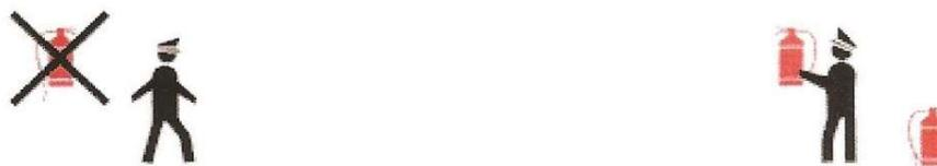
Una volta usato, l'estintore va sostituito con uno identico pieno.
